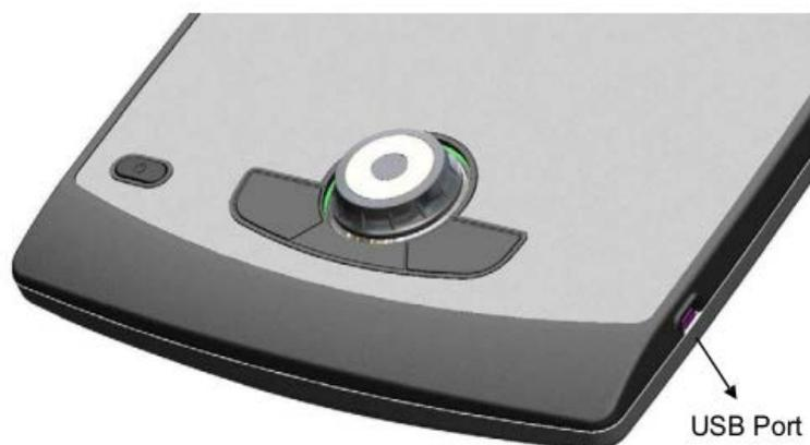
USB-порт можно найти на боковой поверхности консоли. В случае подключения устройства в USB разъем, на консоли загорается соответствующий знак.
